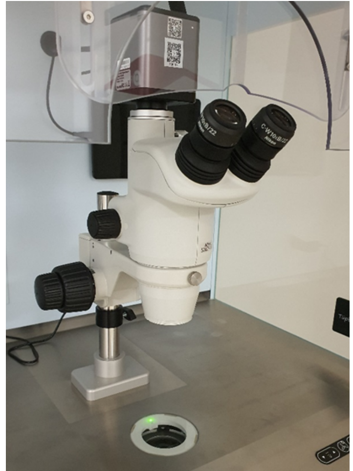
Şekil 2. Çalışma kabinine entegre, kamera bağlantısı yapılmış trinoküler stereomikroskop (SMZ 745T, Nikon, Japonya).
